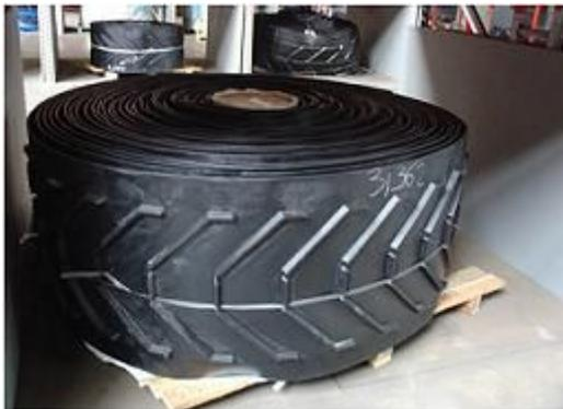
**Резинотканевые шевронные ленты** применяют в работе транспортерных и конвейерных линий для транспортировки грузов с разными углами наклона (до 45 градусов). Возможность перемещать материалы под уклоном обеспечивается за счет того, что ленты шевронные по всей своей длине имеют периодичный объемный профиль.
