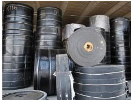
**Норийная лента** является одним из основных элементов составляющих элеваторы, которые транспортируют в вертикальной плоскости с помощью ковшей сыпучие или кусковые грузы. Широкое применение она находит и в качестве приводных резинотканевых ремней, норийную конвейерную ленту еще называют норийным ремнем.
