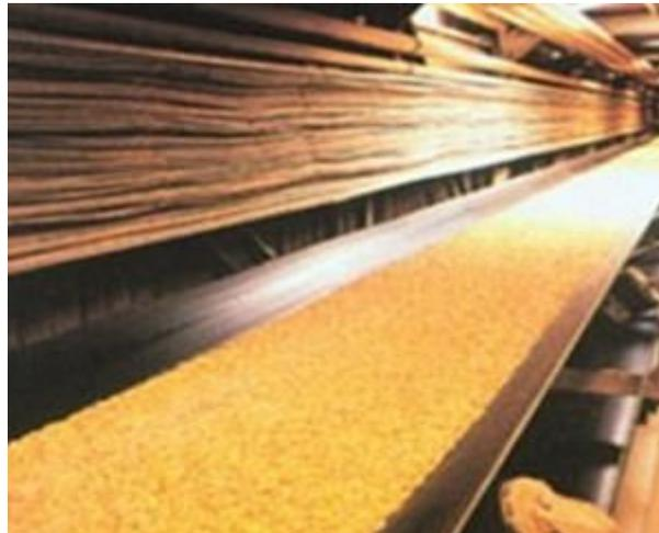
**Маслостойкая конвейерная лента** – востребованное изделие, так как находит применение в различных областях промышленного производства, сельского хозяйства, в работе коммунальных служб, строительстве и др. Стойкость рабочей обкладки маслостойкой транспортной ленты к воздействию смазок, жиров, масел различного происхождения делает ее незаменимой при транспортировке грузов, которые обработаны или имеют контакт с растительными, минеральными, нефтяными маслами.
